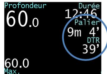
Un ordinateur doté d'un logiciel de calcul de la décompression : paliers, durée totale de remontée.
