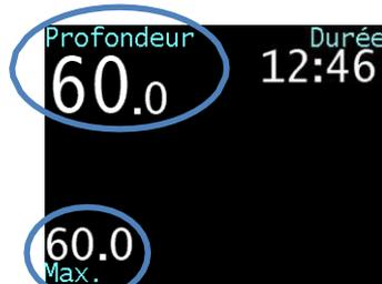
Un capteur de pression pour déterminer la profondeur d'évolution. L'ordinateur conserve en mémoire la profondeur maximale atteinte.
